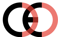
Falsk CE-mærke (for tæt på hinanden)
